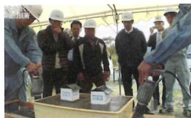
浦安の噴砂を使った液状化実験と説明 の様子
